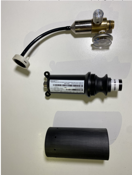
Bước 1. Tháo phần bảo vệ và chuẩn bị dụng cụ hiệu chuẩn
