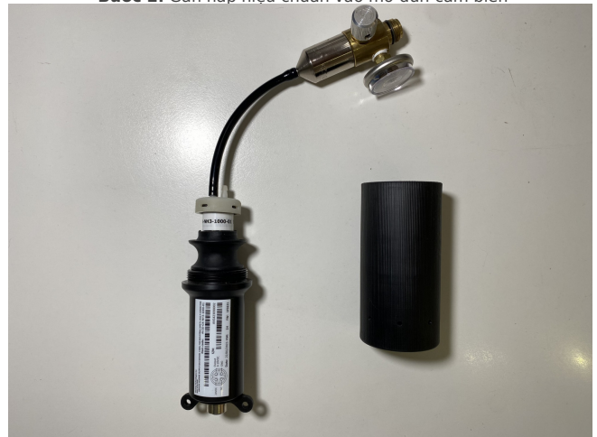
Bước 2. Gắn nắp hiệu chuẩn vào mô-đun cảm biến
